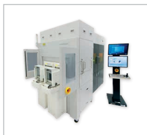
LITHOSCALE® マスクレスリソグラフィ装置 300 mmまでの基板に対応
